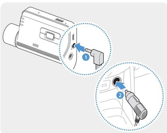
Подсоедините автомобильное зарядное устройство к разъему электропитания DC-IN устройства и вставьте вилку для прикуривателя в розетку питания транспортного средства.
