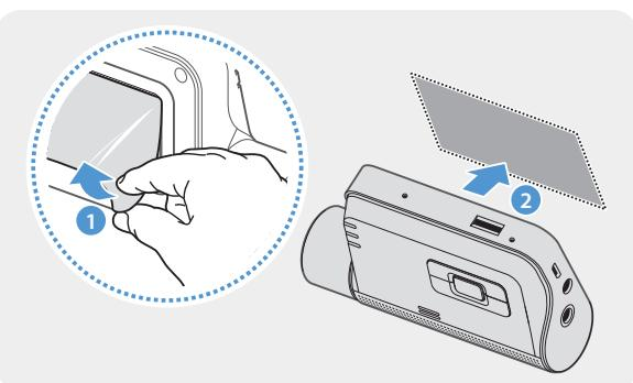
Удалите защитную пленку с клеящегося крепления и прижмите крепление к месту установки.
