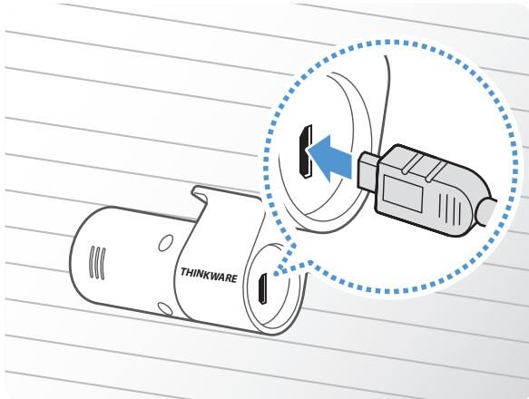
Другой конец кабеля подключите к разъему для подключения на задней камере.
