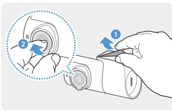
Удалите защитную пленку с kleящегося крепления и объектива камеры.
