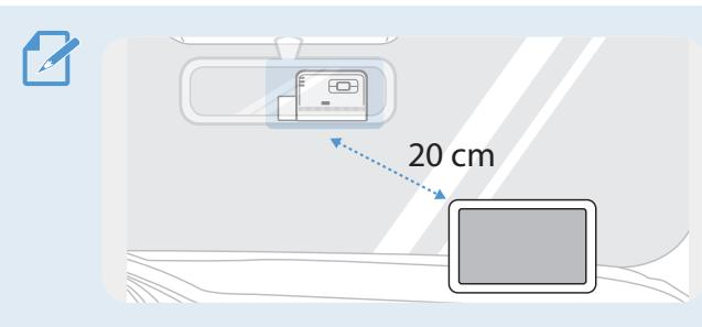
Если на приборной панели установлен GPS-навигатор, то качество приема GPS-сигнала этим устройством может зависеть от места установки видеорегистратора. Отрегулируйте положение GPS-навигатора таким образом, чтобы расстояние между двумя устройствами составляло минимум 20 сантиметров.
