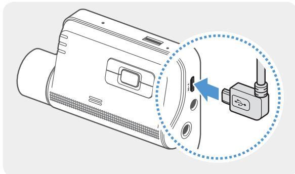
Один конец кабеля задней камеры подключите к разъему V-IN на передней камере.
