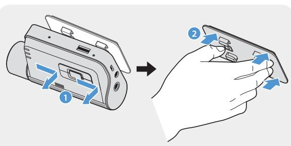
Отсоедините устройство от крепления, прижмите крепление к ветровому стеклу, чтобы надежно его зафиксировать.
