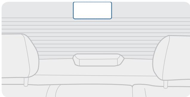
Выберите место на заднем ветровом стекле, где отсутствуют нити обогрева и где камера охватывает обзор позади автомобиля целиком.
